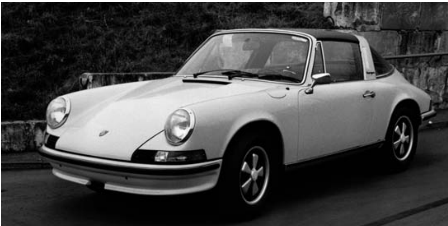
Targan presenteras hösten 1965. En bil med känslan från en cab och säkerheten från en täckt bil. En enkel, genial och dessutom unik idé. Här en 911 S 2.4 Targa från 1973. Den levererade 190 hk vid 6500 varv och toppade 230 km/h.
